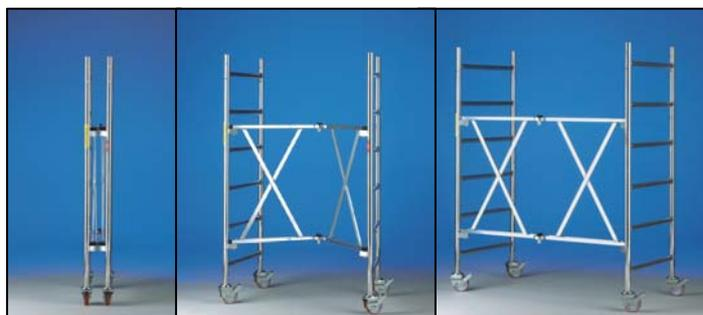
Con l'aggiunta al Modulo A del modulo intermedio C dotato di 4 staffe e del modulo terminale B Jolly può essere montato all'altezza di m 4,47 con un'altezza di lavoro di m 3,70. (A+B+C=24 pezzi da assemblare - Kg 108).
