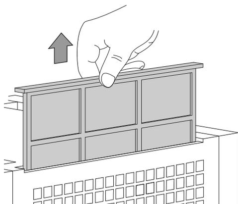
2. Pulire il filtro con un panno morbido, senza pelucchi e leggermente umido. Nel caso in cui il filtro dovesse essere molto sporco, lavarlo con acqua calda mischiata a un detergente neutro.
