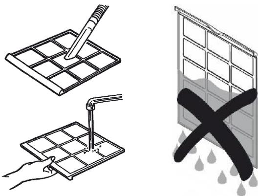
3. Far asciugare completamente il filtro. Non inserire un filtro bagnato nel dispositivo!
