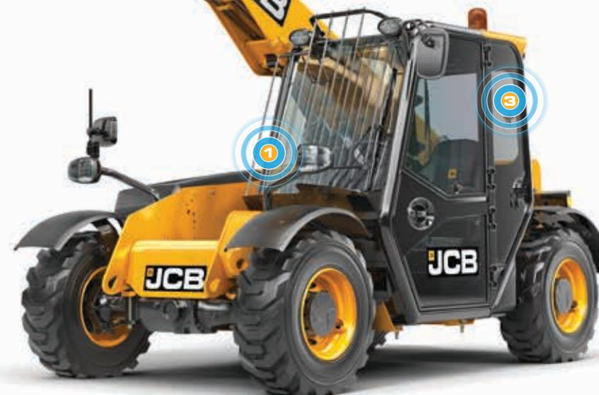
Il controllo di un JCB 525-60 Hi Viz è comodo, preciso e fluido: sono presenti servocomandi elettrici a leva singola con comandi ausiliari proporzionali.
