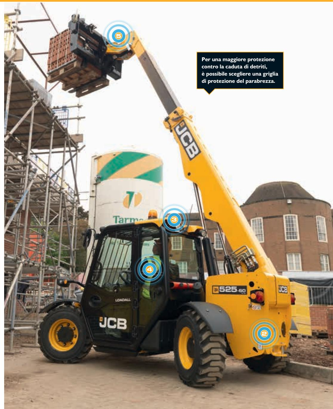
Per una maggiore protezione contro la caduta di detriti, è possibile scegliere una griglia di protezione del parabrezza.
