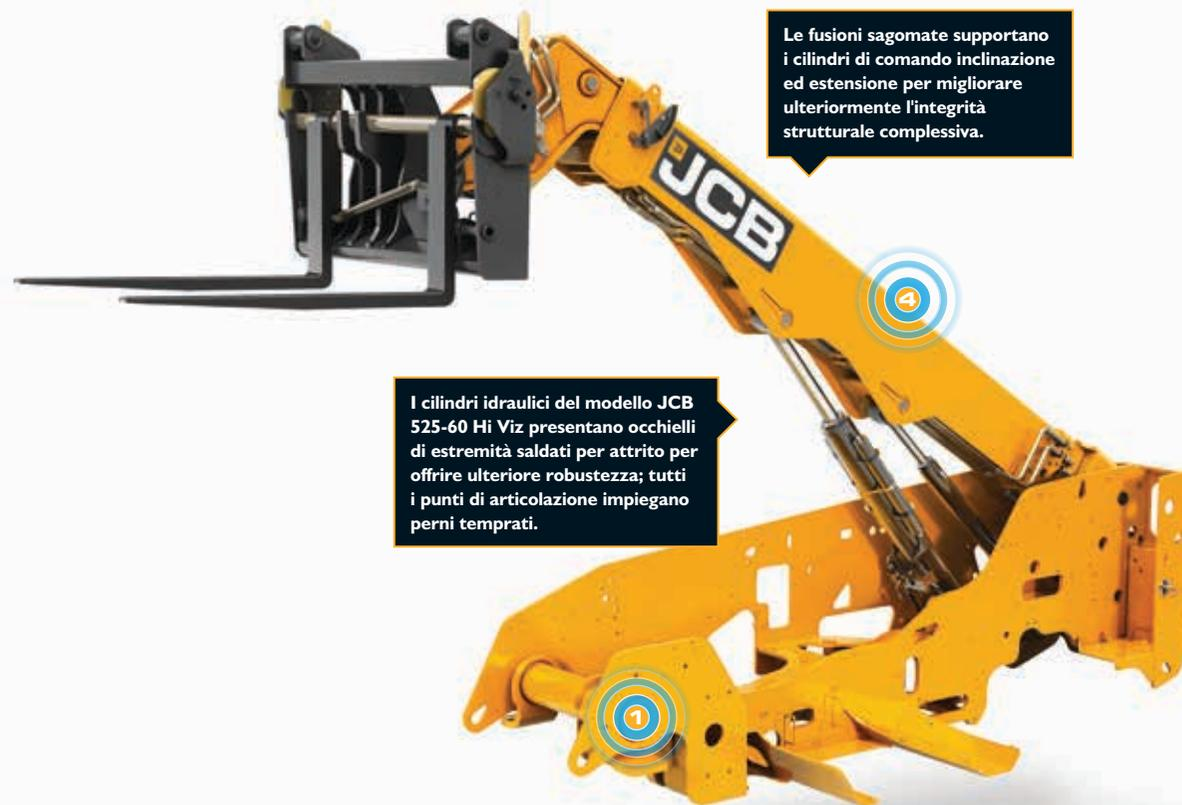
Le fusioni sagomate supportano i cilindri di comando inclinazione ed estensione per migliorare ulteriormente l'integrità strutturale complessiva.
