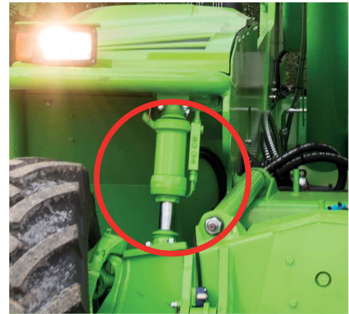
Sistema Tilting per la correzione dell'inclinazione
