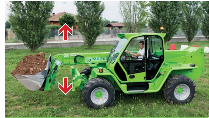
BSS sospensione Idropneumatica del braccio (opt - 12/13 metri). Inseribile dall'operatore, velocizza i trasferimenti e salvaguarda il carico e migliora la produttività. Si disattiva a velocità <3 km/h per mantenere la massima precisione operativa
