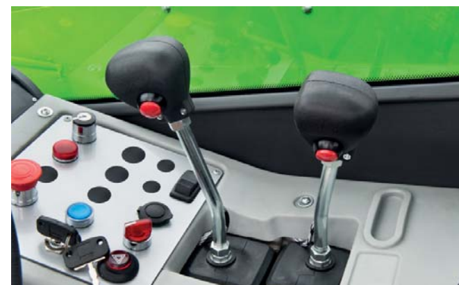
Versione 75 CV: leve per azionamento braccio, zattera, attrezzi e traslazione laterale del braccio
