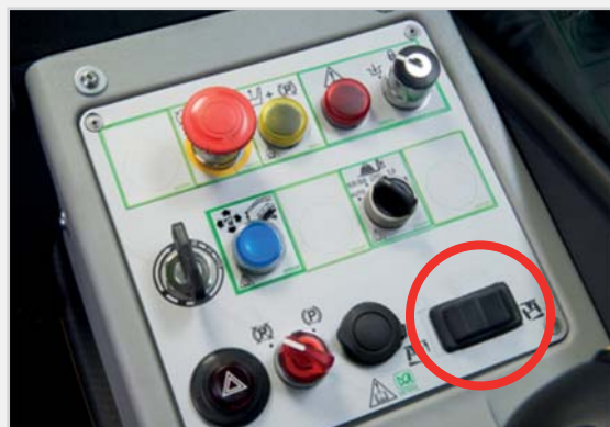
Comando del correttore d'inclinazione trasversale sul pannello di fronte al joystick
