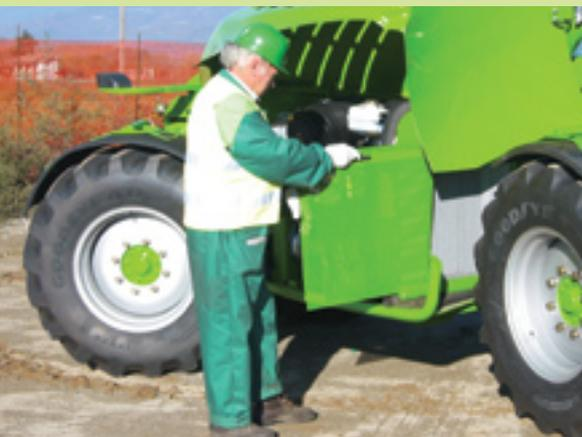
Der Motor kann durch Drehen um die Vertikalachse aus dem Motorraum herausgezogen werden.
