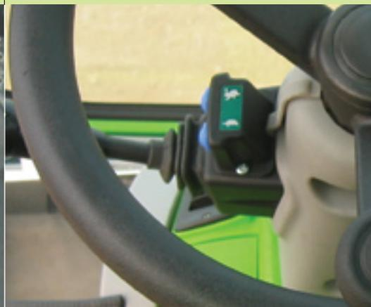
Der Fahrtrichtungsschalter am Lenkrad gestattet dem Fahrer, die Fahrtrichtung umzukehren, ohne die Hände vom Lenkrad zu nehmen.
