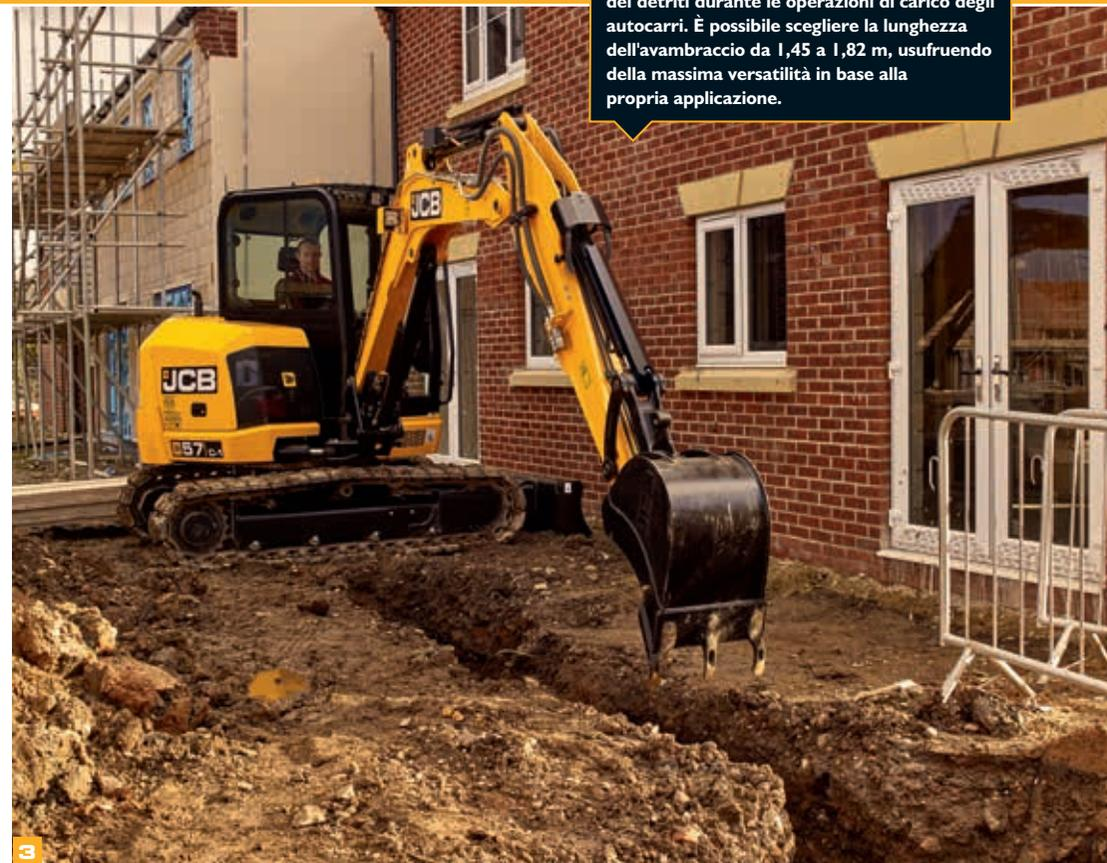
L'enorme angolo di azionamento benna di 181° consente di ridurre al massimo la perdita dei detriti durante le operazioni di carico degli autocarri. È possibile scegliere la lunghezza dell'avambraccio da 1,45 a 1,82 m, usufruendo della massima versatilità in base alla propria applicazione.
