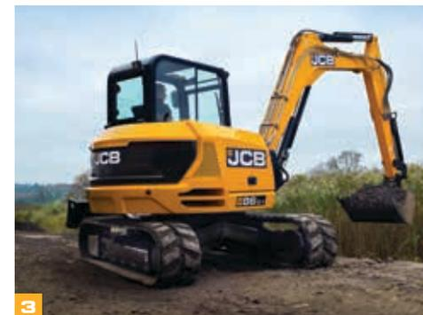
La protezione heavy-duty del cilindro del braccio garantisce una protezione eccellente, con protezioni opzionali dei cilindri avambraccio e benna per le applicazioni più impegnative.
