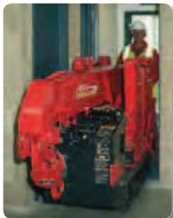
È all'avanguardia tecnologica anche per le sue funzionalità di sicurezza che includono un sistema di avviso vocale intelligente computerizzato e l'esclusiva valvola proporzionale di compensazione della pressione di UNIC, che ne consente l'uso attraverso il radiocomando multifunzione.
